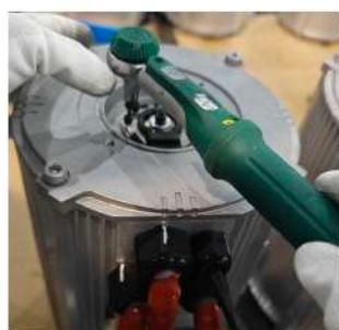
Parafusos de fixação do estator do codificador
