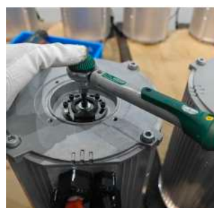
Parafusos de fixação do rotor do codificador
